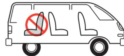
Este asiento elevado debe instalarse en un asiento de vehículo que tenga un cinturón de seguridad de 3 puntos (cinturón de regazo y para hombros). **NUNCA** use solamente el cinturón de regazo.
