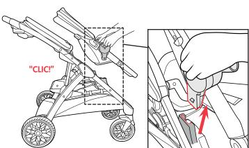
El asiento modular puede retirarse para acoplar el adaptador para asiento de seguridad infantil. Para retirar el asiento modular, presione los botones situados en el interior de ambos cubos, tal como se muestra, y levántelos para extraer el asiento.
