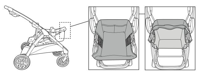
**9** Para plegar el adaptador para asiento de seguridad infantil cuando no se utilice. Levante la estructura delantera y gírela hacia la estructura trasera.
