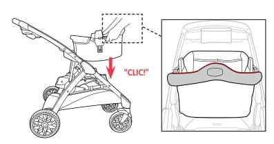
2 Abra el aro del adaptador y localice la curvatura hacia arriba del adaptador. Esta curva siempre mira hacia la parte delantera del cochecito. Alinee las lengüetas de ambos lados del adaptador para asiento de seguridad infantil con las ranuras de la estructura del cochecito, tal como se muestra. Empuje hacia abajo hasta que encaje en su sitio. Tire del adaptador para asiento de seguridad infantil hacia arriba para asegurarse de que quedó firmemente sujetado a la estructura del cochecito.
