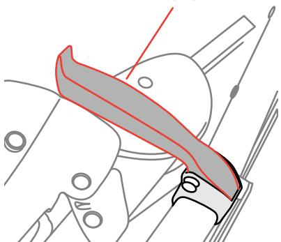
24. La silla de paseo posee de un mecanismo de bloqueo automático. Cierre la silla de paseo después de verificar que el dispositivo de cierre situado al costado del cochecito esté bloqueado correctamente. Esta operación evita que la silla de paseo se abra accidentalmente.
