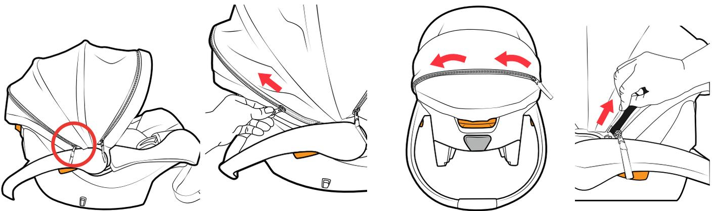
**1** Abra la capota por completo y ubique el cierre en el panel posterior, como se muestra. Abra el cierre y quite la clavija de la caja de retención para separar ambas secciones del cierre.
