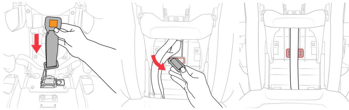
27 Introduzca una esquina de la barra de metal por la ranura del compartimiento del bloqueo de la correa de la entrepierna. Con el asiento completamente reclinado (posición 1), tire de la barra de metal desde la parte de abajo del asiento para que pase por la ranura. Asegúrese de que la barra de metal quede recta en la parte inferior del asiento, como se muestra.
