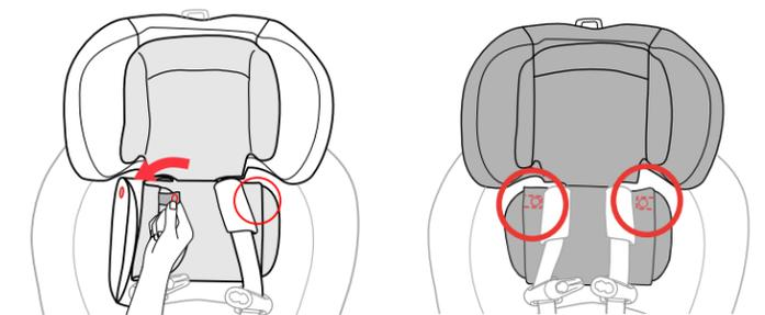
**19** Deslice las correas para los hombros por las ranuras del apoyacabeza, luego abroche los dos botones a presión ubicados en la sección inferior del accesorio para apoyacabeza para las etapas 1 y 2, como se muestra.
