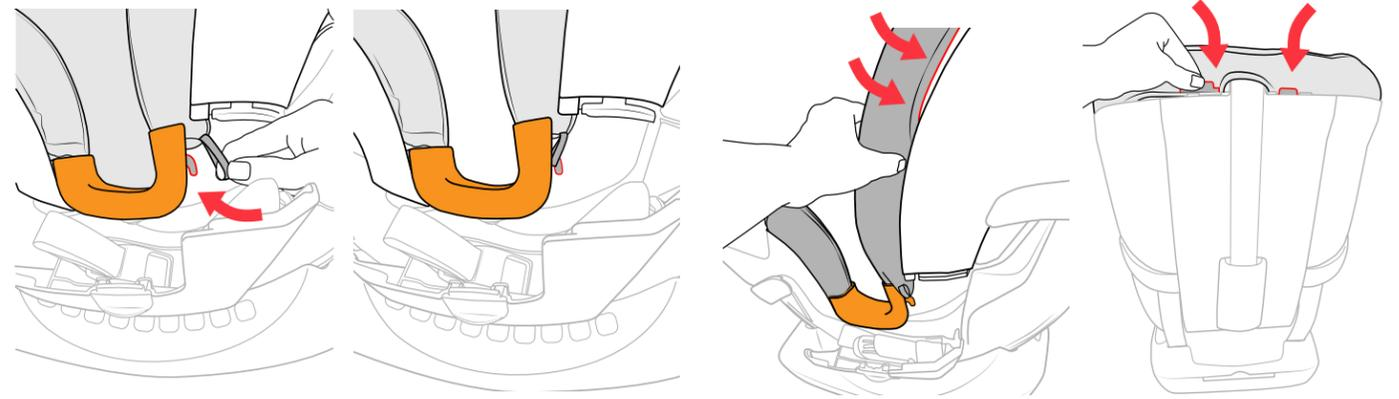
8 Ubique la correa elástica cerca de la parte posterior de la guía del cinturón de regazo, tire de ella y coloque la tela alrededor del borde superior de la guía. Coloque la correa elástica alrededor del poste y dentro del compartimiento del cinturón del sistema LATCH. Cierre el compartimiento y repita el paso en el otro lado.
