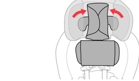
10 **Deslice las dos solapas** de los bolsillos laterales del apoyacabeza. Quite el accesorio para el apoyacabeza para la etapa 1 y 2 del sistema de seguridad para niños.
