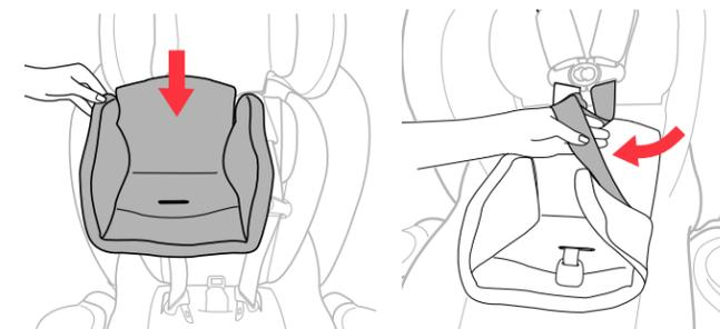
**27 Coloque el posicionador para la etapa 1 del sistema de seguridad para niños.** Pase las correas para los hombros hacia afuera a través de los orificios laterales de la almohadilla y pase la hebilla del arnés por la ranura correcta de la almohadilla.
