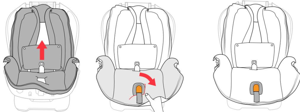
1 Asegúrese de que el apoyacabeza esté en la posición más baja y abra el compartimiento de almacenamiento del sistema LATCH. Coloque la almohadilla del asiento en el marco del sistema de seguridad para niños y pase la hebilla del arnés, de abajo hacia arriba, por la ranura correcta en la almohadilla. Luego, coloque cuidadosamente la tela alrededor de la correa de ajuste del arnés.
