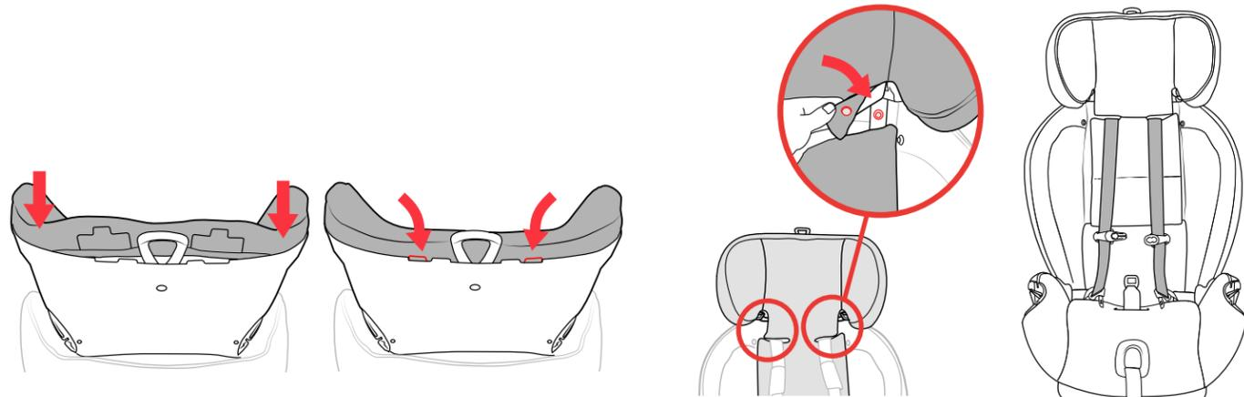
**11** Busque las lengüetas de plástico en el borde posterior del apoyacabeza. Presiónelas contra el marco del apoyacabeza hasta que queden encajadas en su posición, como se muestra.
