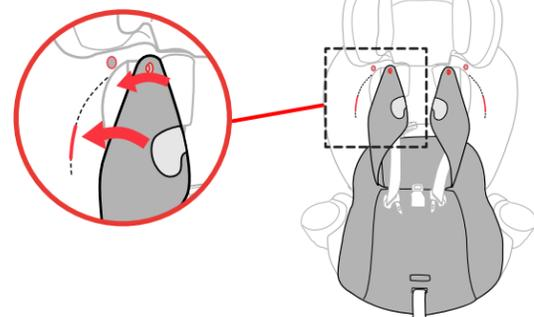
**21 Introduzca la lengüeta de plástico en la hendidura del bolsillo** y abroche el botón a presión superior en el ala lateral del posicionador para la etapa 2. Repita el paso en el otro lado. Verifique que la lengüeta de plástico esté metida hasta el fondo del bolsillo.
