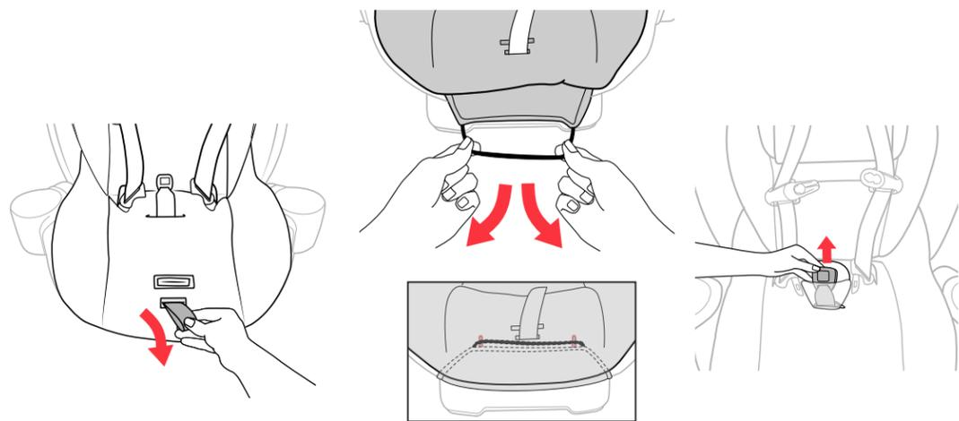
**24 Busque la correa del sujetador y tire de ella para que pase por la abertura de la almohadilla del asiento.** Ajuste la correa elástica de la parte frontal del posicionador para la etapa 2, tire de ella por debajo del borde frontal de la parte inferior del asiento y enlázela alrededor de los dos ganchos. Si lo desea, ajuste la almohadilla de la correa de la entrepierna para utilizar en la etapa 2.
