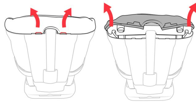
21 En el borde superior del respaldo del asiento, tire suavemente las dos lengüetas de plástico hacia atrás y levante la tela. Retire la tela de la parte superior del respaldo del asiento.
