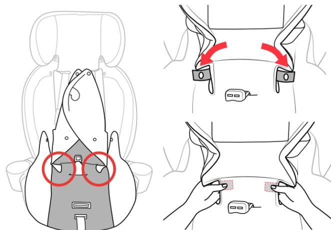
**23 Tire de la tela del asiento y del posicionador para la etapa 2,** como se muestra. Envuelva las dos correas de los botones a presión debajo de la tela del asiento. Con los dedos, alinee y ajuste ambos botones a presión en la parte inferior de la tela del asiento.
