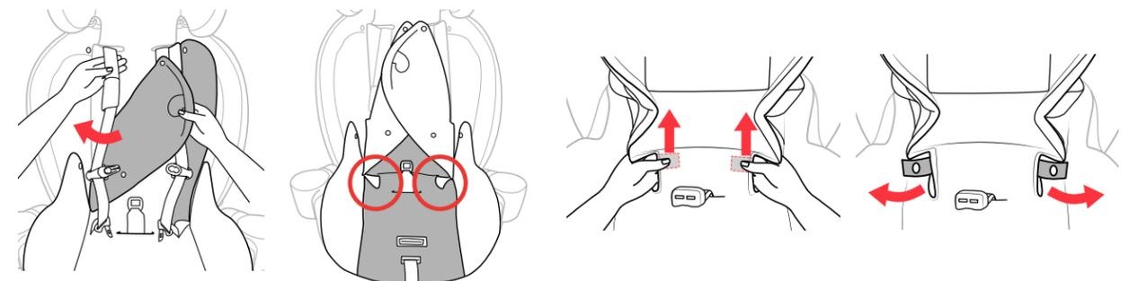
13 **Pase las correas para los hombros por las aberturas laterales** del posicionador para la etapa 2. Tire de la tela del asiento y del posicionador para la etapa 2 hacia adelante, como se muestra. Luego, en la parte de abajo de la tela del asiento, desabroche los dos botones a presión que unen el posicionador para la etapa 2 a la tela del asiento.
