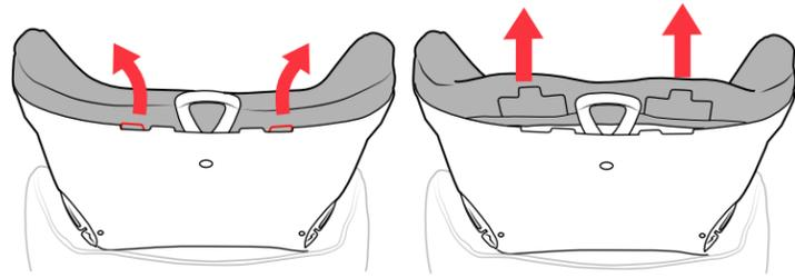
18 En la parte trasera del apoyacabeza, tire suavemente hacia atrás las dos lengüetas de plástico en la parte superior y levante la tela del apoyacabeza.
