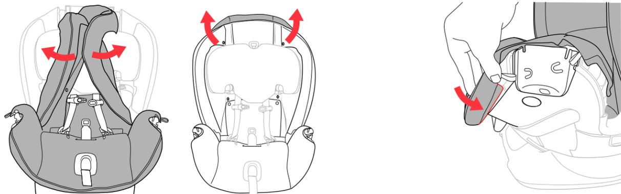
2 Tire de la tela hacia abajo para que cubra el borde frontal e inserte el apoyacabeza en la abertura superior de la tela. Tire de la tela para que cubra la parte posterior del marco del asiento.
