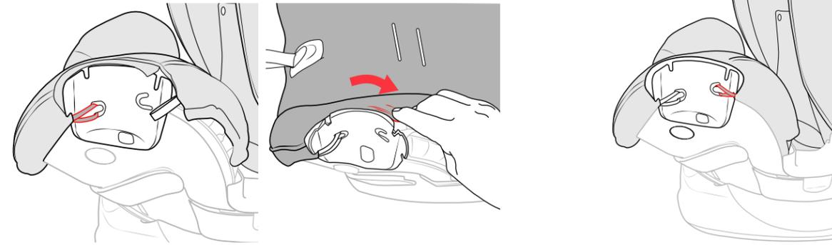
4 Mientras tira de la correa elástica frontal, presione la tela y dirijala hacia la ranura. Envuelva la correa elástica alrededor del poste dentro de la abertura del soporte para vasos. Coloque el borde de la tela alrededor del marco exterior del soporte para vasos y asegúrese de que no cubra las ranuras del marco del soporte para vasos.
