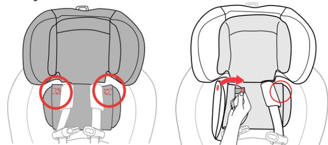
9 **Levante el apoyacabeza hasta la posición más alta.** Desabroche los dos botones a presión ubicados en la sección inferior del accesorio para apoyacabeza para las etapas 1 y 2, como se muestra.
