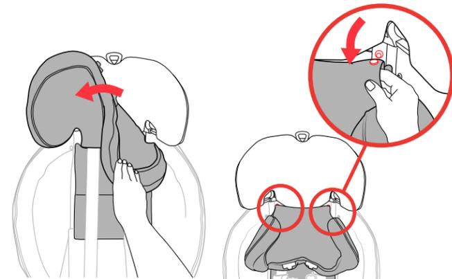
19 Con el sistema de seguridad para niños frente a usted, tire de la tela y retírela del marco del apoyacabeza. Desabroche los dos botones a presión que sostienen la tela del apoyacabeza en su lugar, localizados en la parte inferior del marco del apoyacabeza, como se muestra.
